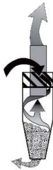
沙漠滤的分离装置原理图
